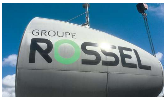
L'éolienne fait 130 mètres de haut et a une puissance de 2,35 MW.
